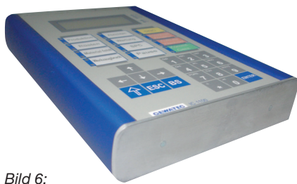
Bild 6: Gewatec hat neben dem ERP-System GPPS auch eine Reihe von Industrie-PCs und -Terminals auf Ethernet-Basis entwickelt, um eine optimale Rückmeldung der Betriebs- und Maschinenzustandsdaten zu gewährleisten. Sie sind dementsprechend robust ausgestattet, z.B. mit Touchscreen und standardmäßigen Schnittstellen (Werkbild: Gewatec GmbH)
