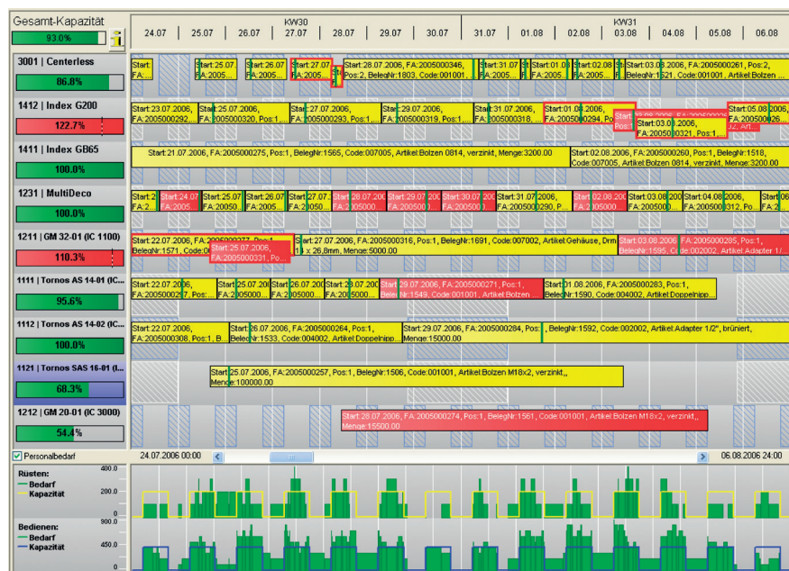
Bild 2: Das Leitstandssystem KapPlan zeigt rot unterlegt die Arbeitsgänge, die den Fertigungstermin überschreiten oder die andere Vorgänge überlappen. Sie lassen sich einfach per drag & drop so verschieben, dass die Termine und die Kapazitäten von Maschinen und Personal (links und unten) passen (Werkbild: Gewatec GmbH)
