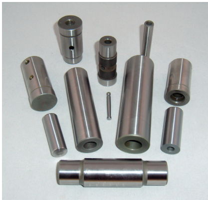
Bild 4: Beispiel für den Bereich CNC-Drehen (Losgrößen von 50 - 20.000) bei 3-Tech: Planetenachsen werden gedreht, gehärtet und geschliffen und einbaufertig angeliefert
