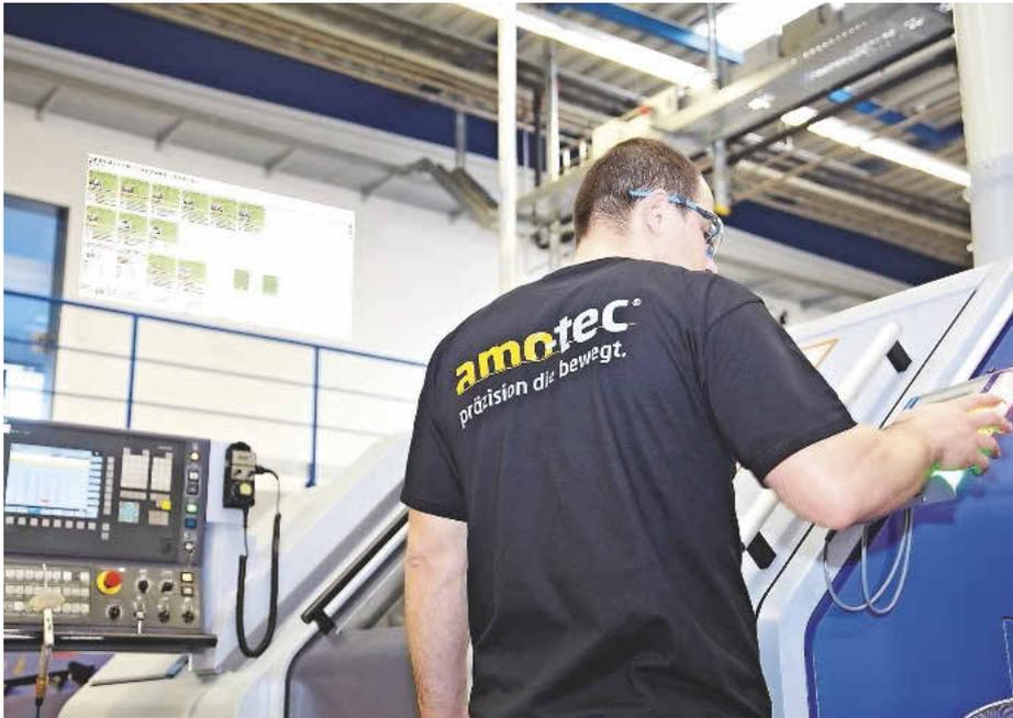
Das Bildschirmsignal des MDE/BDE-Leitstandrechners wird für alle sichtbar per Beamer an die weiße Werkhallenwand projiziert. Damit hat jeder Werker nicht nur „seine“ Maschinen immer im Blick, sondern auch die seiner Kollegen
