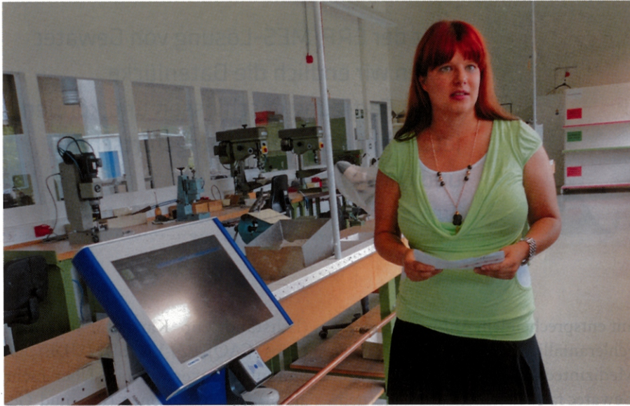
Bild 2 | BDE/MDE-Terminal: Ina Wirth, zuständig für die gesamte Administration, kann direkt an der Maschine Aufträge per Hand oder Barcode an- und abmelden. Zudem werden die Maschinenzustände und die Stückzahlen erfasst, können Störgründe eingegeben werden etc.
