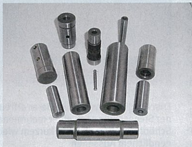
Beispiel für den Bereich CNC-Drehen (Losgrößen von 50 – 20 000): Planetenachsen werden gedreht, gehärtet und geschliffen und einbaufertig angeliefert
