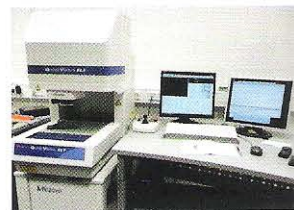
Die 3D-Koordinatenmessmaschine (CNC-Lasermessmaschine) von Mitutoyo gibt die Messdaten direkt ins QS-Modul von Gewatec ein.
