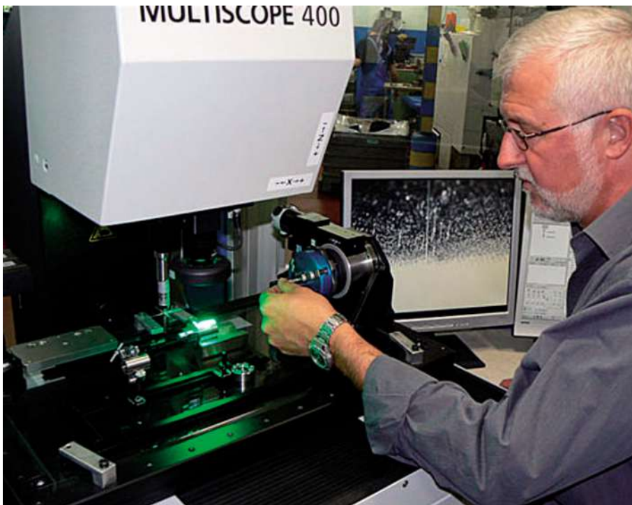
Bild 2: Wenn das Messintervall abgelaufen ist, sendet der Leitreechner einen Impuls an eine Signallampe des BDE-Terminals an der Maschine und fordert den Werker zum Messen auf.
