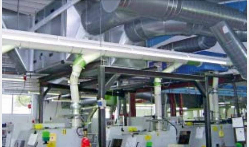
Nahezu alle CNC-Maschinen bei Gotzeina sind mit Datenerfassungs-Terminals von Gewatec ausgerüstet (im Bild unten rechts), damit im BDE/MDE-Modul Pro Vis immer online der aktuelle Fertigungsstand der Aufträge ab-
