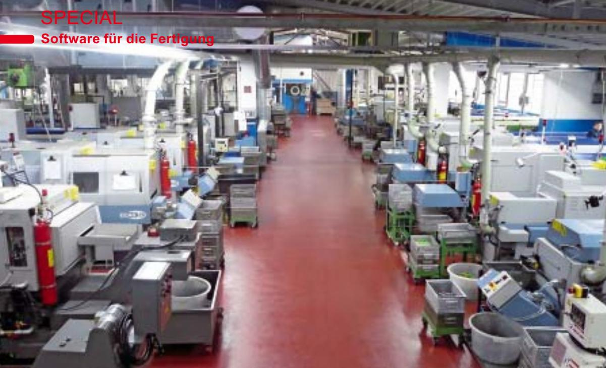
Auf über 40 CNC-Kurz- und Langdrehautomaten sowie CNC-Bearbeitungszentren fertigt Gotzeina Drehtechnik Präzisionsdrehteile in Komplettbearbeitung und führt CNC-Lohnbearbeitungen durch. Bilder: Gotzeina Drehtechnik
