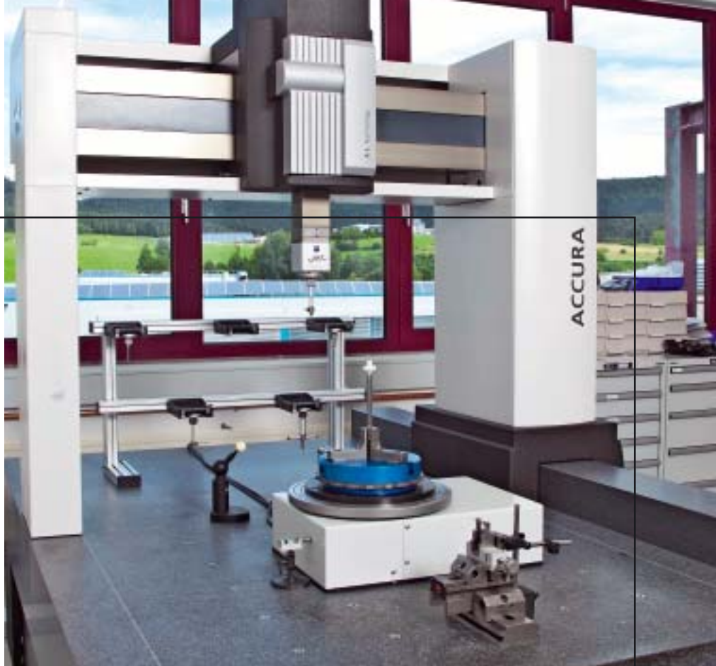
Um einen weiteren Schritt in der Prozesskette zu schließen, hat HPC eine 3D-Portal-messmaschine zum Vermessen der bemusterten Teile angeschafft. Bilder: HPC
