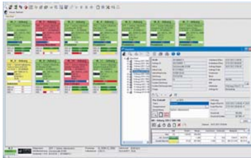
Mit dem BDE/MDE-Leit- rechner lässt sich online der Zustand aller Maschinen in Echtzeit anzeigen
