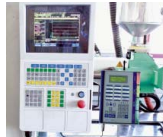
Mit den Informationen der auf der rechten Seite des Terminals integrierten Prozessampel (vier Signalebenen) kann der Werker bei Qualitätsproblemen von Prozess und Maschine sofort gegensteuern
