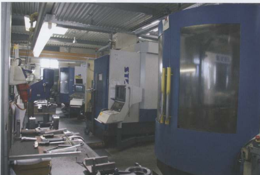
Bild 4: Highlight des Maschinenparks sind drei verkettete 5-Achs-Bearbeitungszentren, ausgerüstet für den mannlosen Betrieb inklusive Werkzeugspeicher und Identifizierung (Werkbilder: Gewatec GmbH & Co. KG, Wehingen)
