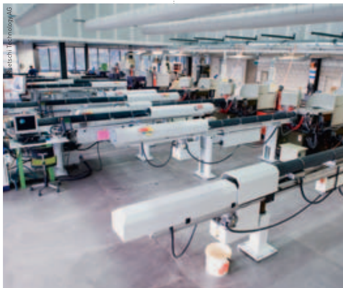
Blick in eine der klimatisierten Werkhallen von Ruetschi mit CNC-Langdrehautomaten, auf denen hochgenaue Teile mit bis sechs Tausendstel Millimeter Toleranz hergestellt werden.
