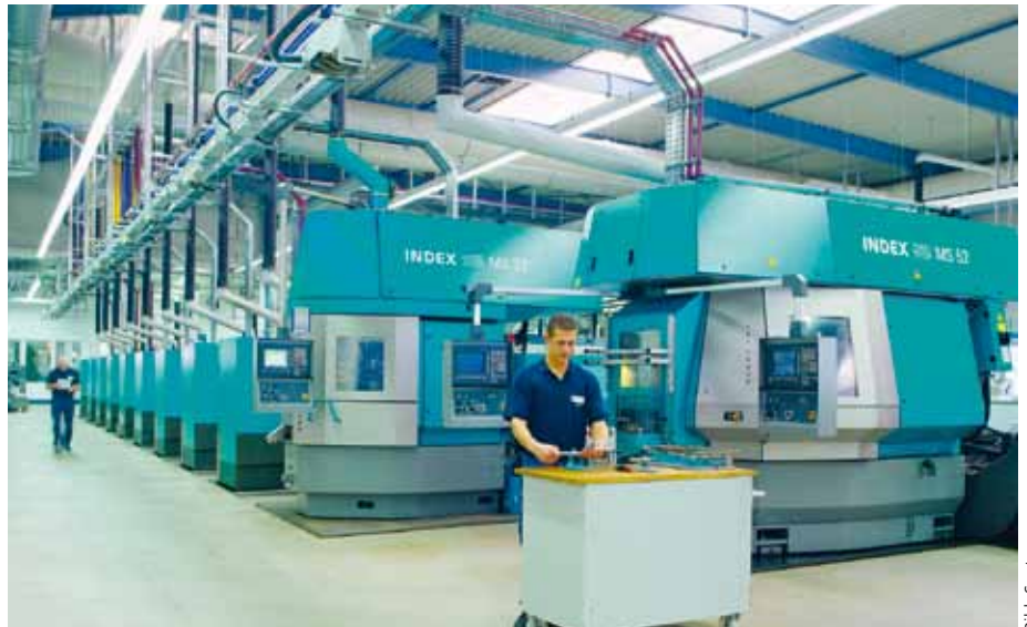
Bild 2: An Drehautomaten mit bis zu sechs Spindeln werden im 3-Schicht-Betrieb gut eine halbe Million Teile am Tag produziert.
