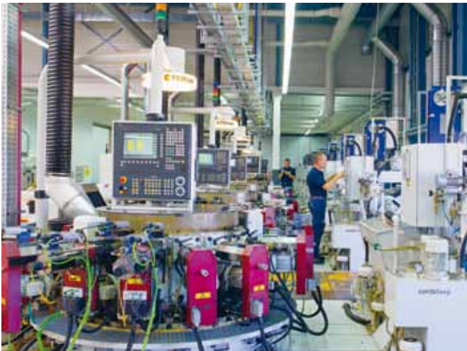
Bild 4: Der Werker sieht im CAQ, wann die Messungen anstehen, oder er wird auch von einer Signallampe auf dem MDE-Terminal daran erinnert.
