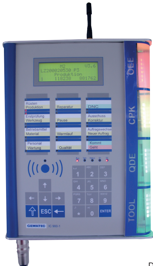
Bild 2: Mit dem MDE/BDE-Terminal von GEWATEC kann der Werker z.B. direkt an der Maschine die Aufträge per Hand oder Barcode an- und abmelden, werden die Maschinenzustände und die Stückzahlen erfasst, können Störgründe eingegeben und die DNC-Programme an die Maschine übertragen und zurück zur Sicherung an den Server gegeben werden
