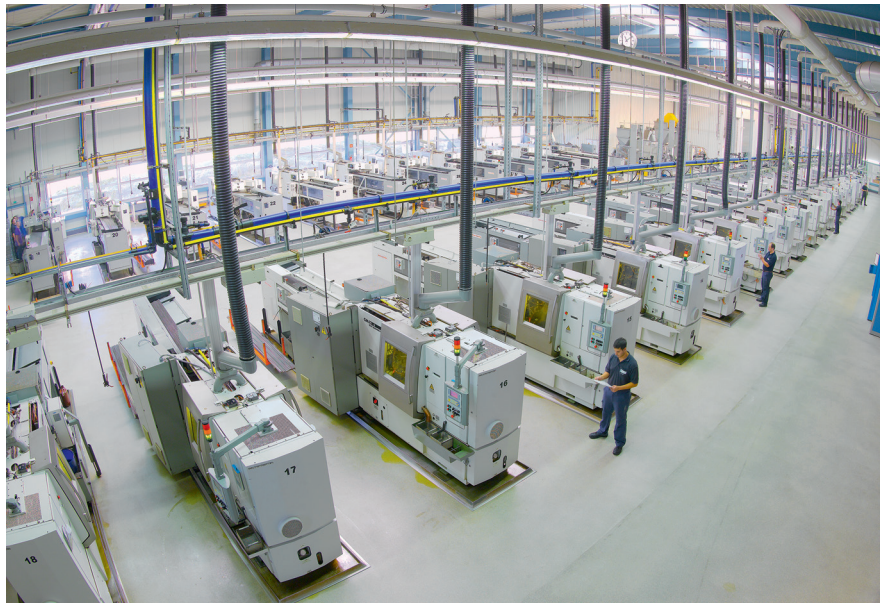
Bild 4: An Drehautomaten mit sechs Spindeln (konventionell und CNC) fertigt Sauter im 3-Schichtbetrieb gut eine halbe Million Teile am Tag. Das ist ohne eine unternehmensweit integrierte Informationsverarbeitung und eine Optimierung der Warenflüsse nicht möglich
