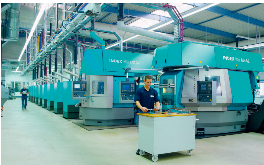
Bild 6: Die Arbeitsplätze genügen höchsten Sauberkeitsanforderungen: Ölrückstände bei der umweltgerechten Reinigung und Späne werden recycelt, die Luft mit modernen Filteranlagen gereinigt und die dabei entstehende Restwärme zur Beheizung der Gebäude genutzt (Werkbilder 2-6: Sauter GmbH, Wehingen)
