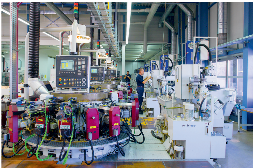
Bild 5: Hydromat-Rundtaktmaschinen von Pfeiffer zur Fertigung von rotationssymmetrischen Werkstücken mit bis zu einem Spanndurchmesser von 45 mm und einer Gesamtlänge von 150 mm. Die Teile werden rund um die Uhr in Großserien für die Automobilindustrie (für z.B. Bremssysteme) gefertigt
