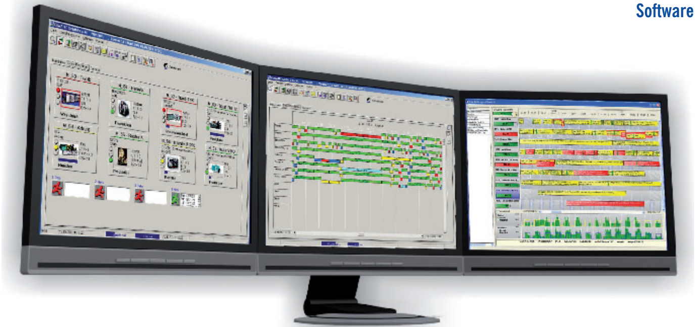
Bild 4. Der BDE/MDE-Monitor zeigt den Online-Zustand der Maschinen (links). In der Mitte ist das Laufzeitdiagramm und Störgründe zu sehen, rechts das Leitstandsystem mit der Einsatz- und Engpassplanung.
