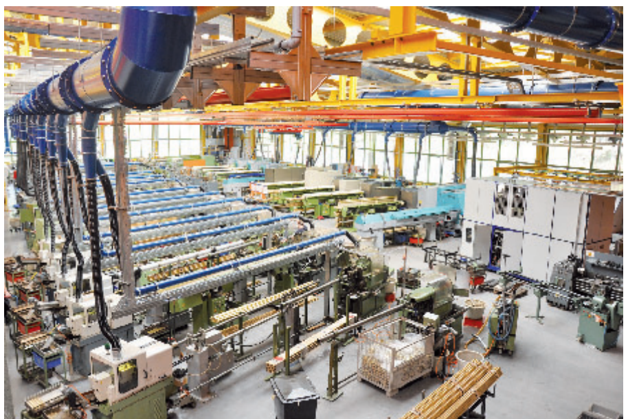
Bild 2. Der Maschinenpark bei August Weckermann besteht aus 80 Drehmaschinen (die Hälfte davon CNC-Maschinen), 80 Spezialmaschinen zum Diamantieren und elf Bearbeitungszentren.
