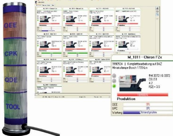
*Mit Hilfe der Prozessampel auf Basis der Online-BDE/MDE-Datenauswertung kann der Werker auf einen Blick erkennen, wie es um die Leistungsfähigkeit der Maschine oder die Qualität des Prozesses steht.*
