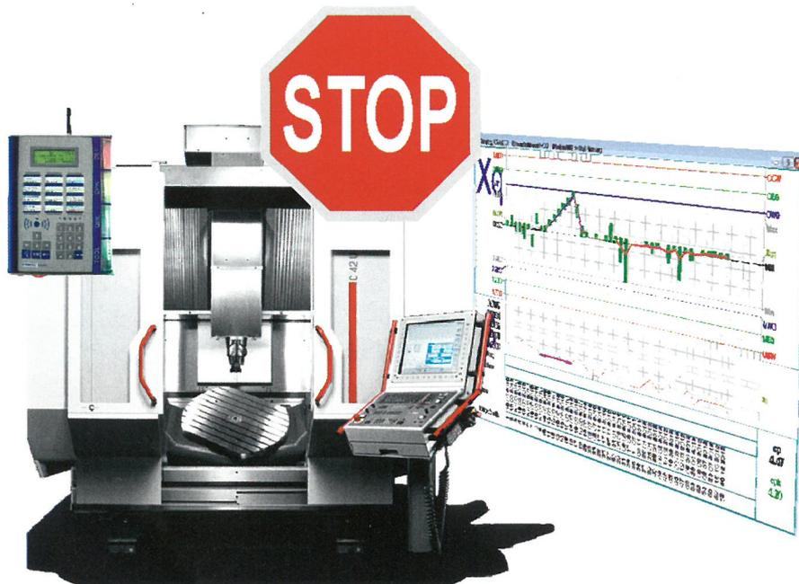
**Bild 5:** Industrie 4.0 funktioniert nur dann, wenn die verschiedenen Prozesse einer Fertigung miteinander verzahnt sind. Durch die Verknüpfung von Qualitätsmanagement und Produktionssteuerung kann beispielsweise eine Maschine automatisch gestoppt werden, wenn ein Merkmal eines Werkstückes außerhalb der Fertigungstoleranz liegt. Der Zwangshalt der Maschinen wird dann per Email oder SMS an den Maschinenbediener gesendet (Werkbilder: GEWATEC GmbH & Co. KG, Wehingen)
