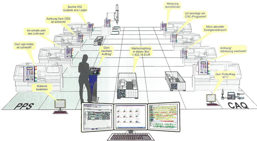
**Bild 1:** Industrie 4.0 in einer mittelständischen Fertigung: Die Visualisierung von Fertigungszuständen ist der erste Schritt, um einen vernetzten Betrieb zu steuern. Im zweiten Schritt kommunizieren Sensoren und Aktoren miteinander, informieren den Werker, entscheiden selbstständig und lösen vollautomatisch Aktionen aus
