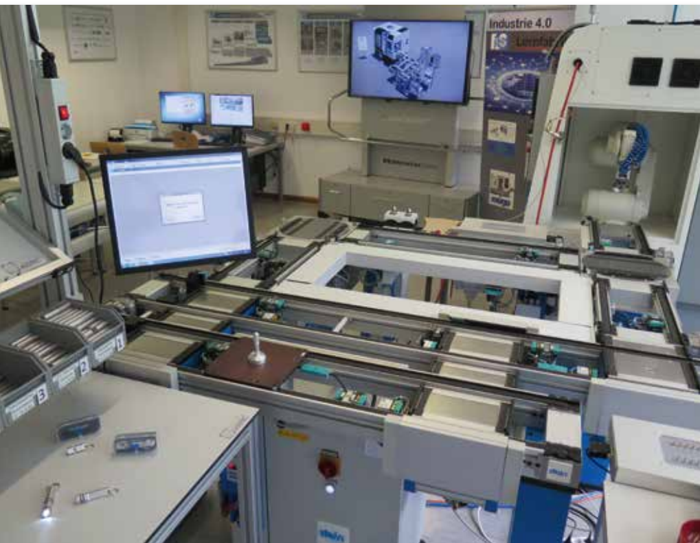
Blick auf die Lernfabrik mit Handarbeitsplatz (im Vordergrund), Transportsystem des Werkzeugträgers und Bearbeitungszentrum mit Roboter (rechts). Im Hintergrund der Bildschirmaufbau für den Cyber-Classroom. Basierend auf den Erfahrungen wird die „Industrielle Lernfabrik 4.0“ jetzt als schlüsselfertiges Gesamtsystem angeboten.
